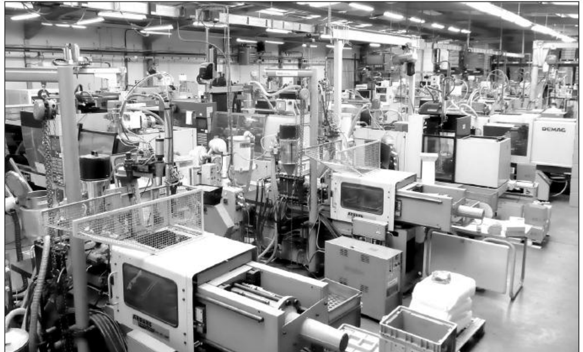
Astic Injection Industrielle dispose aujourd'hui d'un parc-machines composé d'une vingtaine de presses à injecter d'une puissance de 20 à 320 tonnes capables de transformer annuellement 350 tonnes de matières premières en des pièces de quelques grammes à 1 kg.
